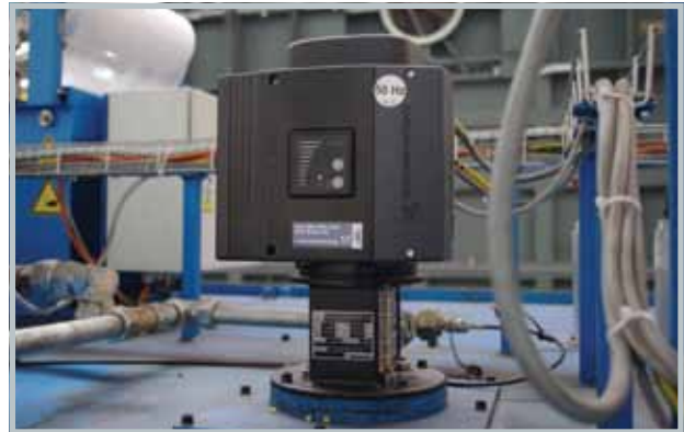
MTR Pumpen sind vertikale mehrstufige Kreiselpumpen, ausgelegt für das Pumpen von Kühlmittel in Maschinenwerkzeugen, Ableiten von Kondensat und ähnliche Anwendungen.
