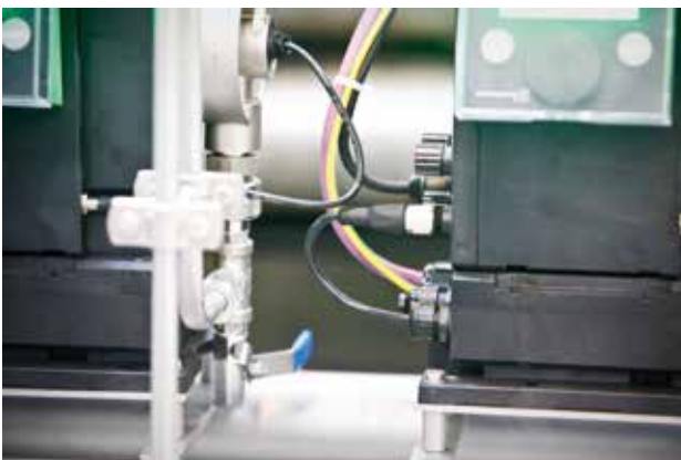
Eine Digital Dosing DDA-Membranpumpe von Grundfos kann stufenlos in einem Bereich von 1:1000 bis 12.000 ml/h eingesetzt werden.
