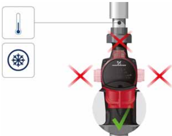
Joonis 4 Juhtploki asendid, õhu konditsioneerimise ja külmaveesüsteemid
