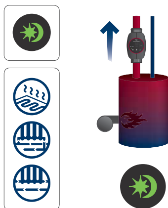
Abb. 22 Wenn das grüne Leuchtfeld leuchtet, ist die automatische Nachtabsenkung aktiviert.
