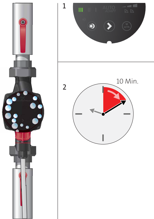
Abb. 25 Entlüften der Pumpe
