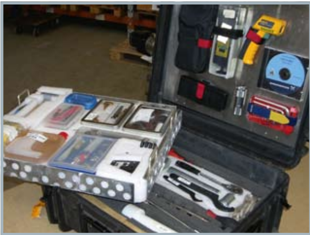
Der Grundfos Service Deutschland hält Emergency-Tools mit allen relevanten Spezial-Werkzeugen bereit, die für die Instandsetzung und Prüfung eines BM-Moduls erforderlich sind.
