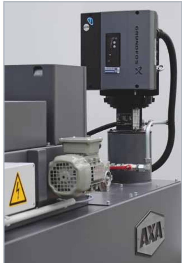
Eine MTRE-3-Pumpe im Test bei der AXA – sie erreicht den geforderten Druck von 30 bar und das Fördervolumen von 35 l/min.
