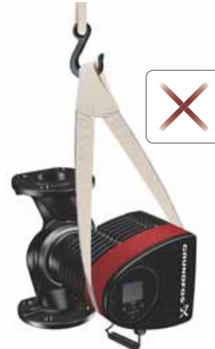
Abb. 2 Falsches Anheben der Pumpe
